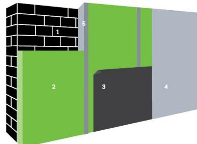
1. Buitengevel | 2. Isolatie | 3. Dampscherm | 4. Binnenaafwerking | 5. Stijl- en regelwerk (optioneel)
