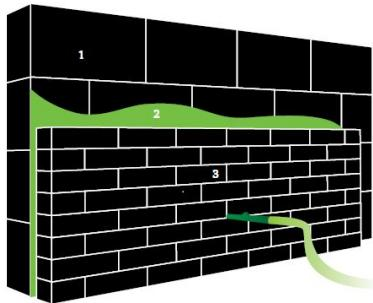
1. Dragende muur | 2. Ingeblazen isolatie | 3. Gevelsteen / gelbekleding
